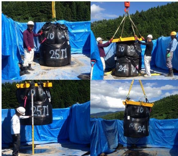
Fig.18 フレキシブルコンテナバッグの耐久性確認試験 (福島県環境創造センター実施)
