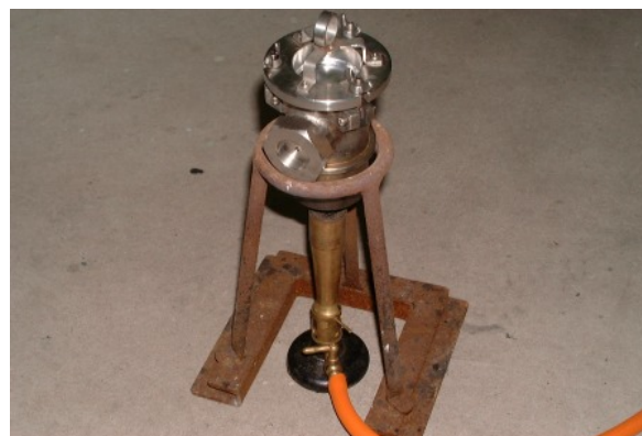
図 2 圧力容器試験装置
