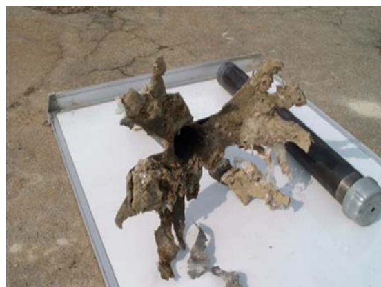
図 3 右の鉄管に試料を入れて爆発させ、鉄管の破断状況から判断する (試料: ヒドロキシルアミン 70% 水溶液)
